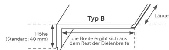
**2 x eingeschlagen;** Das Profil eignet sich für gerade und gewendelte Treppen. Optional Verkleidung der Setzstufe möglich mit 2 mm PVC-Platten in weiß.
