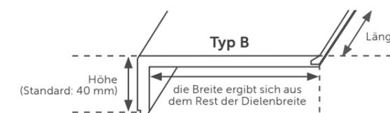
**1 x eingeschlagen;** Das Profil eignet sich für gerade und gewendelte Treppen. Ist für eine Ausführung von Blockstufen ausgelegt. Waagerechte und senkrechte Verkleidung der Stufen.
