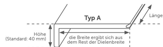
**1 x eingeschlagen;** Das Profil eignet sich für gerade und gewendelte Treppen. Optional Verkleidung der Setzstufe möglich mit 2 mm PVC-Platten in weiß.
